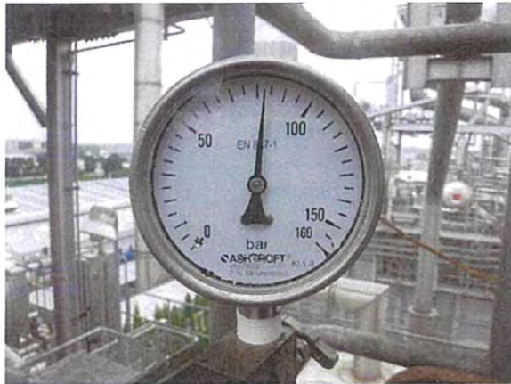
ภาพที่ 7 ภาพถ่ายแสดง Pressure Gauge ขณะทำการอัดน้ำ Hydrostatic Test เพื่อทำการทดสอบหม้อไอน้ำ ส่วน High Pressure Section ของหม้อไอน้ำ ที่ระดับ ความดัน 82.0 Bar g.
